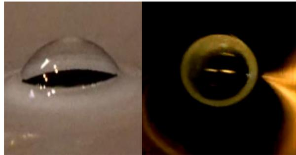
**figure 1** - Photos des bulles à la surface de l'eau, vu de profil (à gauche) et vu de dessus (à droite).
