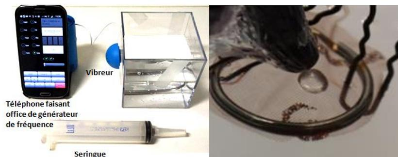
Figure 5 – Dispositif pour l'étude de la vibration forcée d'une bulle d'air
